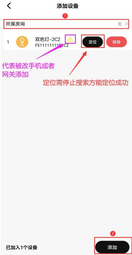
③点击需要添加的设备后的“加入”按钮，如果不确定是不是这个设备，可以点击“定位”，设备会做出相应的动作以提示位置(灯设备会闪 3 下，“定位需停止搜索后方能定位成功”);
